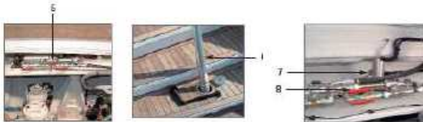
5 - Ventil des Richtungszyinders 6 - Notpinne. 7 - Schraube + Mutter zur Befestigung der Notpinne. 8 - Zylinderventil in By-pass-Stellung
