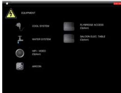
Acceso a los menús equipos (permite poner en tensión o fuera de tensión los distintos equipos del barco)
