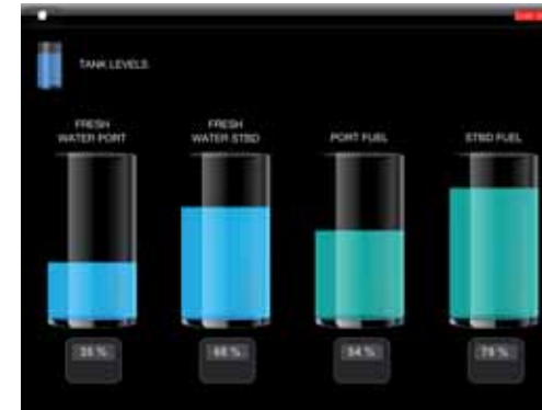
Menú depósitos (permite controlar los niveles de los depósitos de agua y carburante)
