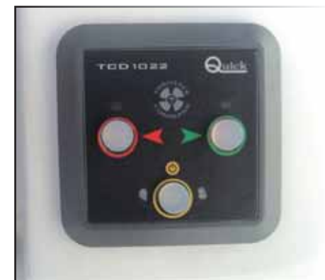
4 - COMMANDE DU PROPULSEUR D'ETRAVE
