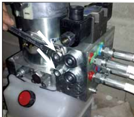
ECROUS DE VERROUILLAGE DE CENTRALE HYDRAULIQUE
