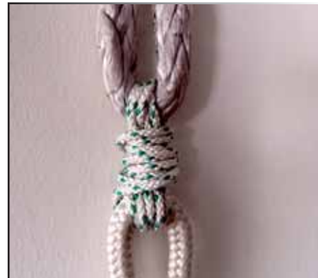
SURLIURE ENTRE LA DRISSE ET SON EXTENSION
